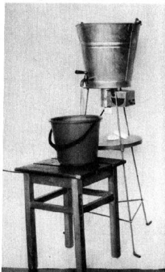
Elektryczna termia ustawiona na trójnogu zespawanym ze stalowych prętów
