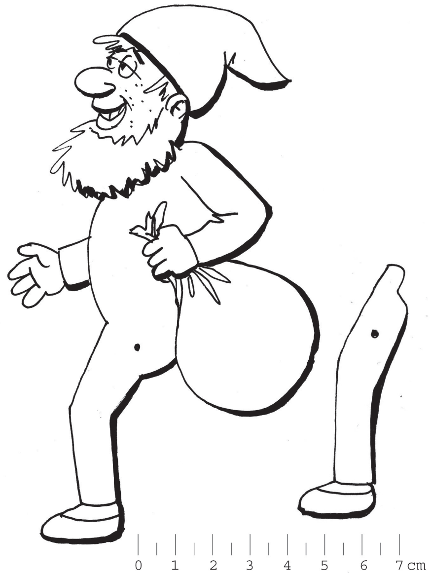
Rysunek 1. Sylwetka postaci krasnala i jego ruchoma noga. Kropki są bardzo ważne, bo wyznaczają położenie osi obrotu
