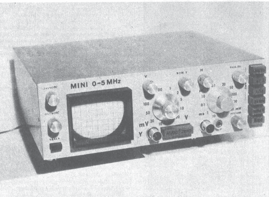
Miniaturowy oscyloskop zmontowany w metalowej obudowie. Ekran lampy oscyloskopowej znajduje się za szybką z naniesioną na nią skalą
