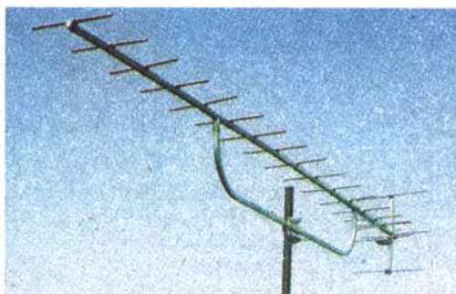
Typowa, wieloelementowa antena typu Yagi-Uda do odbioru programów TV w kanałach 20–40
