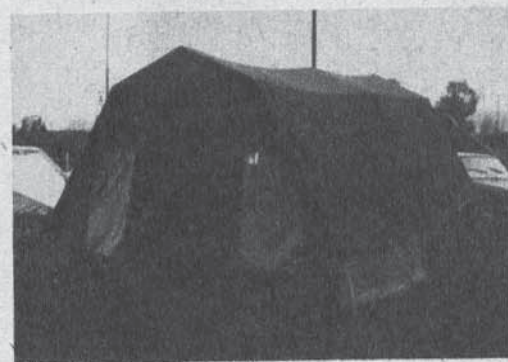
Przyczepka z trzema miejscami do spania i z namiotem rozpiętym na szkielecie z rurek aluminiowych. Z pełnym wyposażeniem turystycznym waży 140 kg
