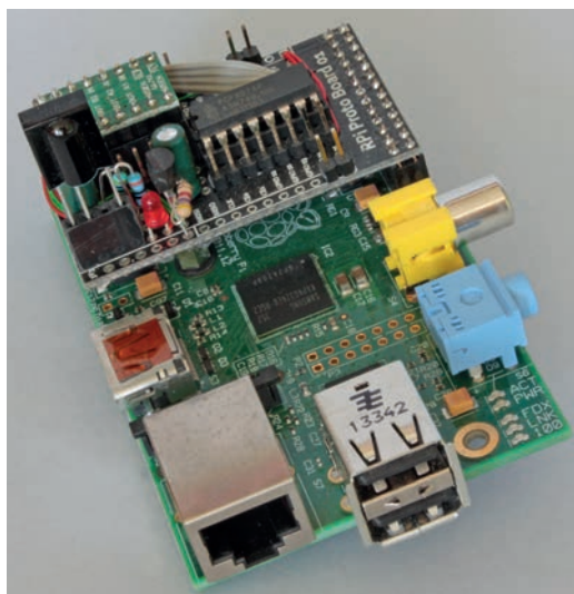
4. Raspberry Pi z płytką prototypową do sterowania ciężarówką; widoczny ekspander portów I 2 C PCF8574AP, sterownik silników DRV8833 i odbiornik podczerwieni TSOP1238
