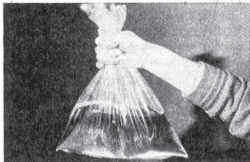
Fot. 2. Samodzielnie zgrzany woreczek z płynem odznacza się dużą wytrzymałością mechaniczną
