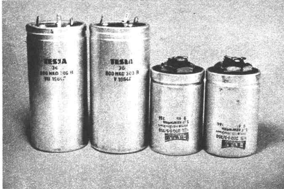
Fot. 3. Kondensatory elektrolityczne zastosowane w zasilaczu prototypowym
