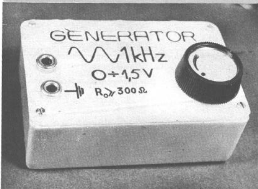
Fot. 3. Zewnętrzna strona obudowy generatora drgań sinusoidalnych
