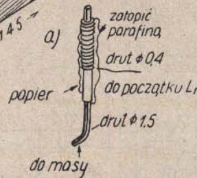
Rys. 5 a) Kondensatorek dostrojeniowy
