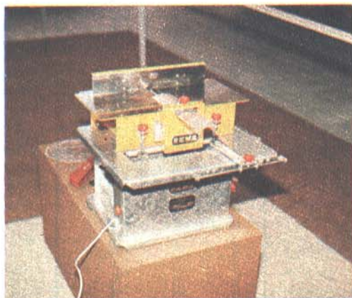
Obrabiarka „DYDA” z założoną przystawką przygotowaną do strugania drewna. Maks. szerokość strugania 200 mm, głębokość 1 mm, nominalna średnica wału nożowego 60 mm, prędkość obrotowa wału 5.000 obr./min
