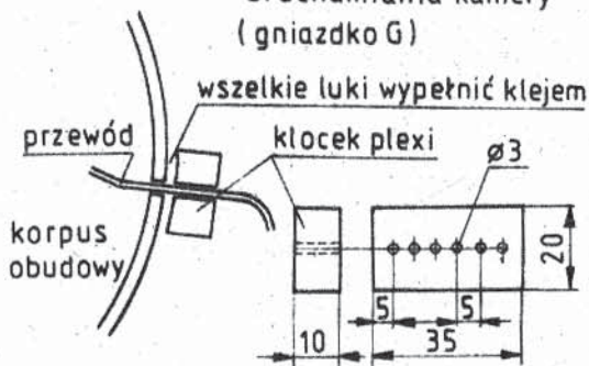
Rys. 11 Wyprowadzenie przewodów z obudowy
