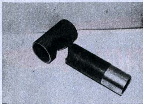
Stalowe rurki tworzące kominek piecyka przygotowane do zespawania
