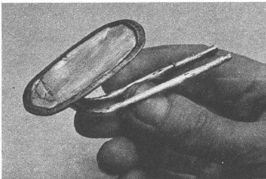
Urządzenie napędowe motorówki przygotowane do wlotowania w kadłub
