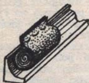
Rys. 3. Klocek do szlifowania żłobków lub półokrągłych wgłębień ściernym papierem. Sporządza się go z pasek filcu lub grubego sukna zwiniętych w walek i owiniętych papierem ściernym
