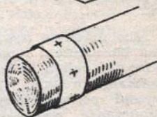
Rys. 5. Sposób wyznaczania osi otworów na powierzchniach okrągłych. Otwory wyznacza się na pasku papieru za pomocą linii. Pasek nakleja się na okrągłą powierzchnię, punktuje się ją na przecięciu dwóch kresek i wywierca otwory dowolnym wiertłem
