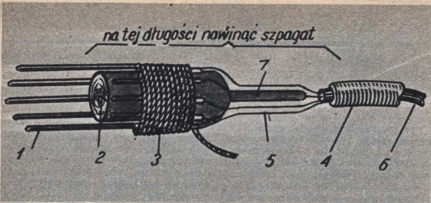
Rys. 17. Wtyczka kabla od strony samochodu: 1 — drut miedziany o \phi 1,5 mm, 2 — koleczek drewniany, 3 — nici lniane, 4 — rurka izolacyjna do nasadzania na trzpień (1), 5 — przewody, 6 — kabel, 7 — trzpień izolacyjny osadzony w koleczku
