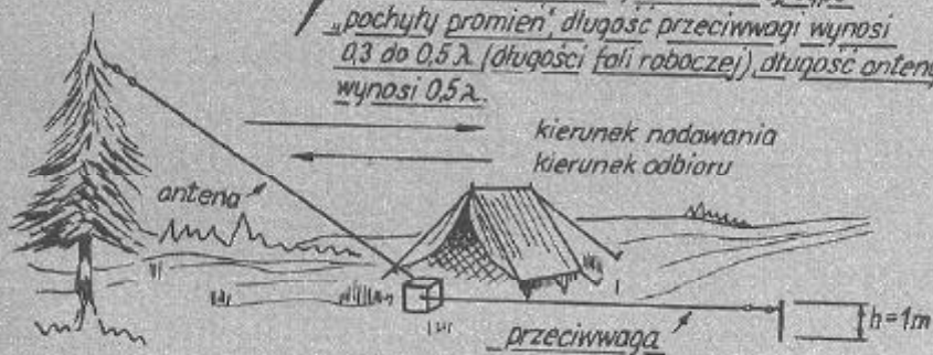
Rys. 3. Konstrukcja niesymetrycznego dipola poziomego.
