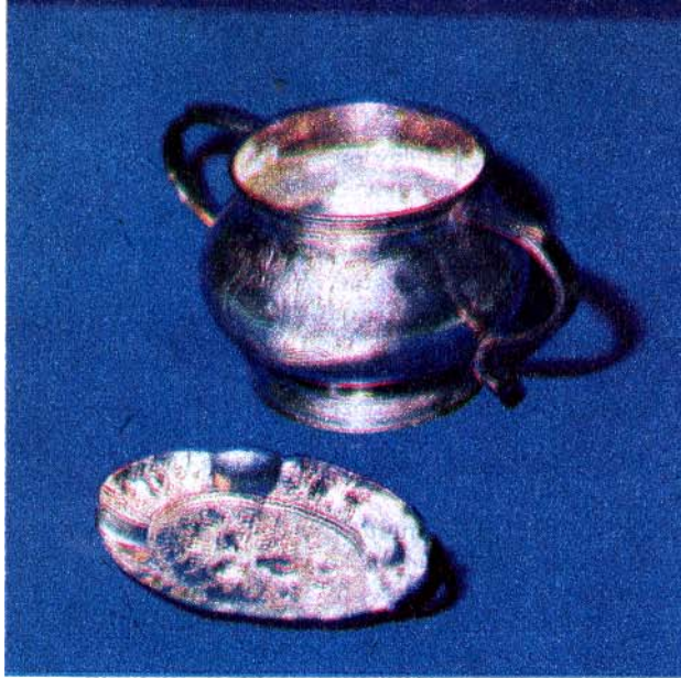
Srebrna cukiernica i popielniczka w 6 miesięcy po oczyszczeniu. Cukiernica nie była pasywowana, popielniczka – pasywowana
