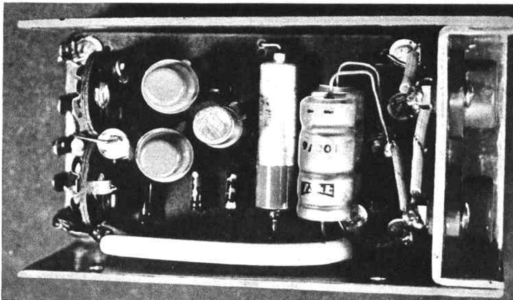
Fot. 1. Wzmacniacz wmontowany w obudowę z polistyrenu.
