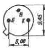
Tranzystor germanowy stopowy (PNP) TG 50-55 (stara obudowa)
