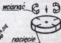
Rys. 8b. Sposób zamocowania blaszek stykowych na bebenku
