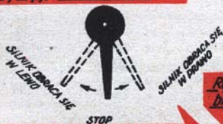
Rys. 8c. Położenie dźwigni w czasie sterowania
