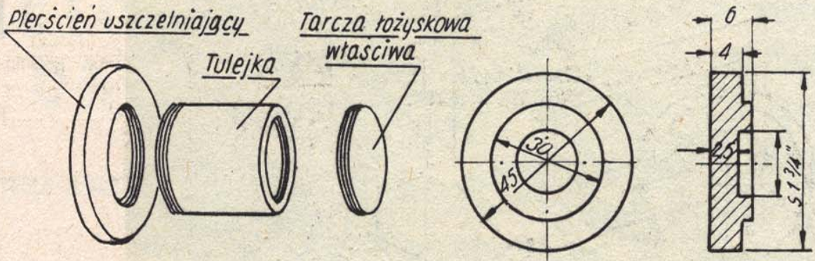
Rys. 5. Tarcza łożyskowa od strony kolektora Rys. 5c. Tarcza łożyskowa wtasciwa
