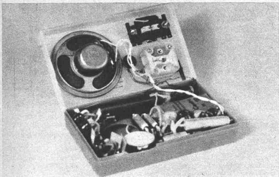
Wnętrze odbiornika „Elektron M” w wersji dwuzakresowej z przełącznikiem zakresów i kondensatorem zmiennym od „Minora”
