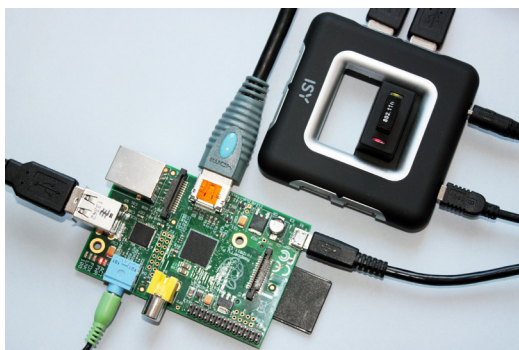
1. Wersja „desktop” – Raspberry Pi B z aktywnym hubem (tu wpięte: karta Wi-Fi, klawiatura i mysz); połączony przez HDMI, dźwięk przez wyjście analogowe
