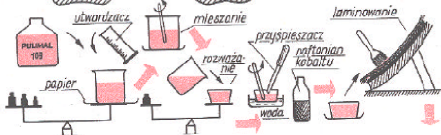
Rys. 3. Schemat technologiczny przygotowania żywicy z dodatkami do wykonania żelkotu. Przy użyciu wagi kuchennej odmierzamy odpowiednią ilość żywicy, do której dodajemy utwardzacz (metodą miareczkowania). Po rozważeniu masy do mniejszych naczyń dodajemy przyspieszacz miareczkowany pipetą
